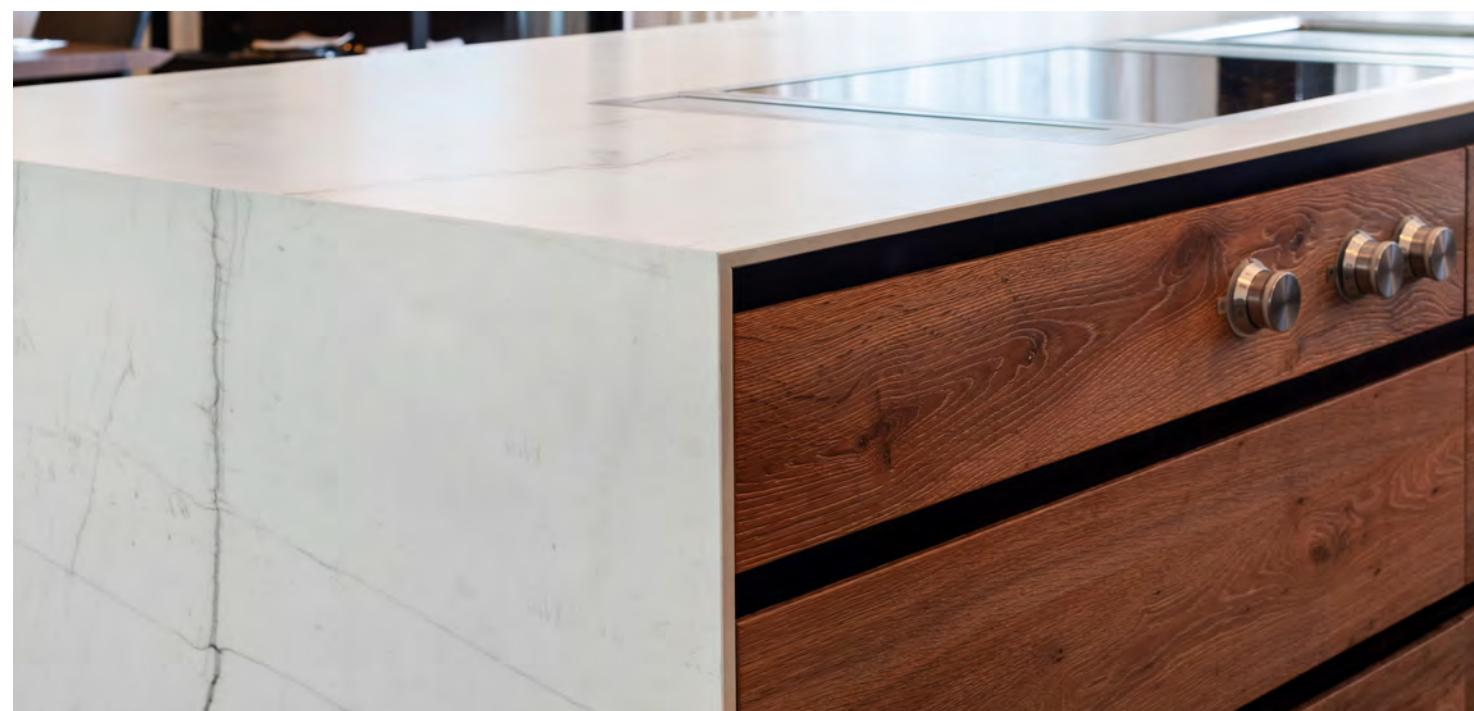
La tecnologia di Sinterizzazione consiste nel sottoporre le materie prime naturali al 100% a pressione e temperature elevatissime. In un'ultima fase, l'insieme di materie prime passa per una pressa in cui viene applicata una forza/pressione fino a 400 bar. In una seconda fase, la lastra passa per un forno con una temperatura superiore ai 1.200 °C. In questo modo la sinterizzazione conferisce a Neolith® delle caratteristiche fisico-meccaniche senza precedenti nell'industria edilizia.
