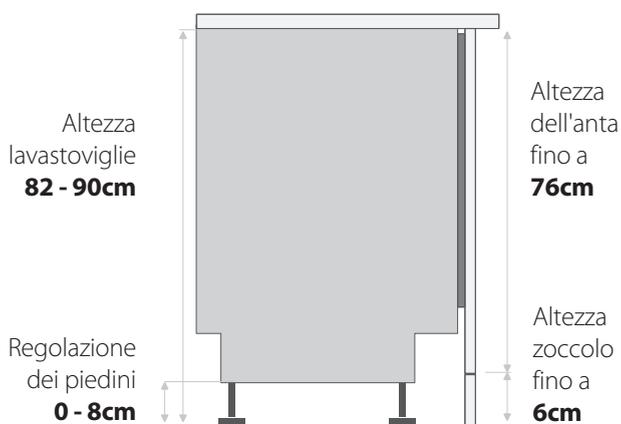
Le nuove cerniere scorrevoli supportano **pannelli di peso differente, da 3kg a 10kg con spessore da 16mm a 25mm**.
